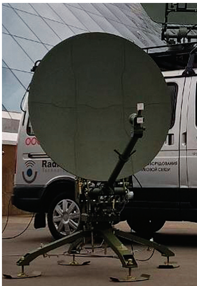
Рис. 5. Антенна 1,2 м С-, Ku- или Ka-диапазонов частот типа Flyaway с автоматическим наведением
